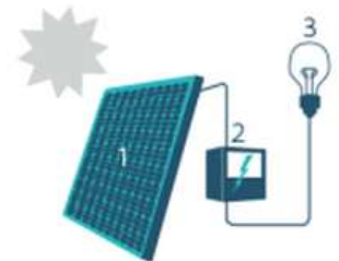
1. Zonnepaneel | 2. Omvormer | 3. Elektrische toestellen
